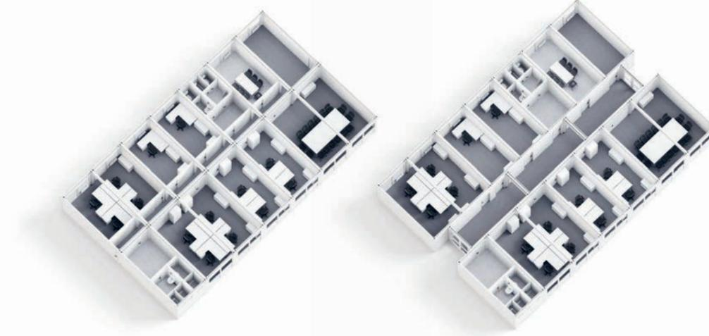
Flure verbinden einzelne, abgetrennte Raumeinheiten wie beispielsweise Gruppenräume. Je nach verfügbarer Aufstellungsfläche bietet ELA zwei unterschiedliche Flursysteme. Bei ausreichend Platz sorgen separate Flurcontainer dafür, dass die volle Nutzfläche der Räume erhalten bleibt. Ist die verfügbare Fläche begrenzt, lassen sich Flure innerhalb der Raumcontainer mit Trennwänden abteilen.
